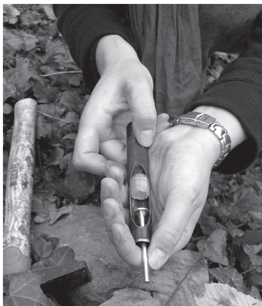
FIG. 3. — Sortie d'un échantillon de bois de Prunus avium L. par la gouttière de l'emporte-pièce. Release of a Prunus avium L. wood core by the punch gutter.
